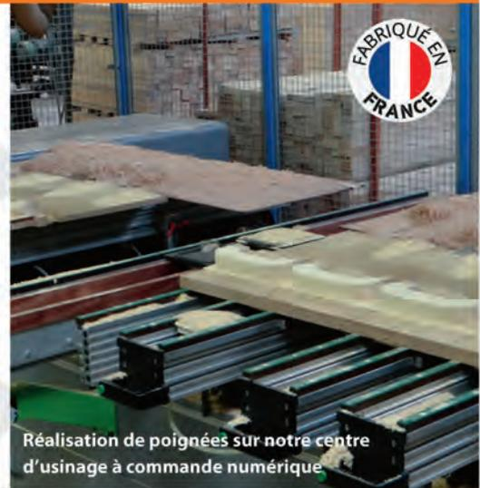
Réalisation de poignées sur notre centre d'usinage à commande numérique
