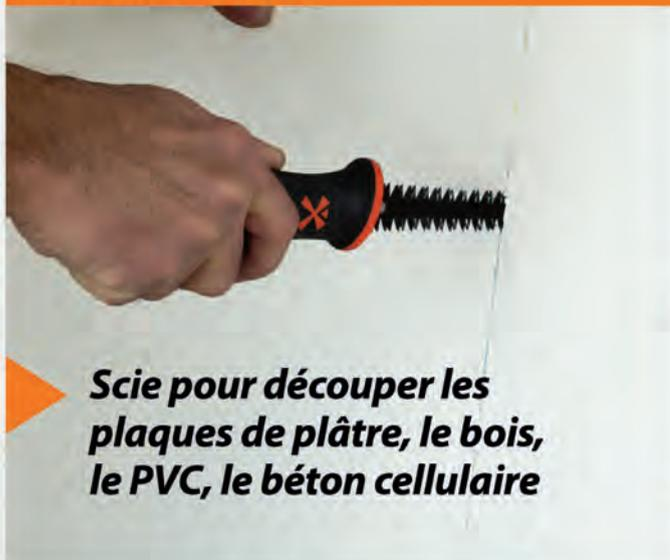
**Scie pour découper les plaques de plâtre, le bois, le PVC, le béton cellulaire**
